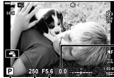
โหมดถ่ายภาพ ความเร็วชัตเตอร์ ค่ารับแสง ค่าการชดเชยแสง
