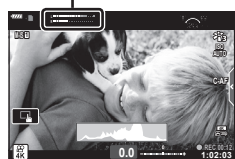
録音レベルメーター
