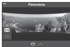
3 Markieren Sie eine Schwenkrichtung mit  $\triangle \nabla \triangleleft \triangleright$  und drücken Sie die  $\odot$ -Taste.
