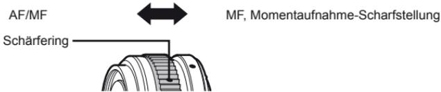
Bei der Momentaufnahme-Scharfstellung wird die Entfernung mit dem Schärferring entsprechend dem Abstand zum Motiv eingestellt. Die Kamera fokussiert über eine dem eingestellten Blendenwert entsprechende Schärfentiefe.
